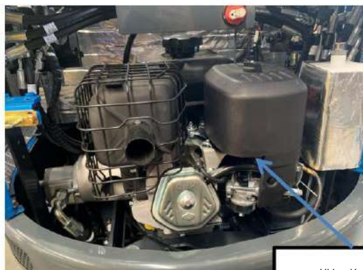
Ubicación del filtro de aire
